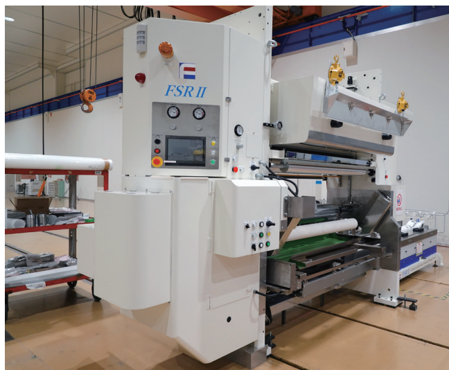
写真1 版胴とファニッシャーロールを自動で交換する グラビア印刷機ユニット「FSR II」
